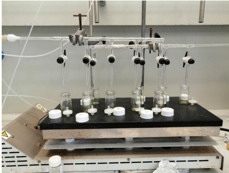
Figura 3-12. Sistema, mediante nitrógeno y placa de calor, empleado en la evaporación de los filtros y tubos.
