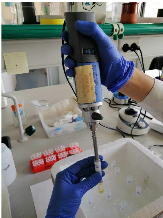
Figura 3-15. Homogenización muestras con Polytron VDI 12.
