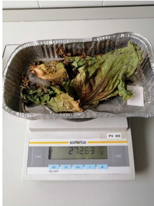
Figura 3-7. Determinación del peso seco con la balanza Sartorius BP 310 S de 0,001 g de resolución.
