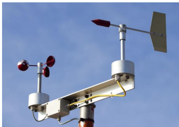
Figura 2.17: Imatge d'un anemòmetre amb vela per calcular la intensitat i direcció del vent. Font: meteorologiaenred.com
