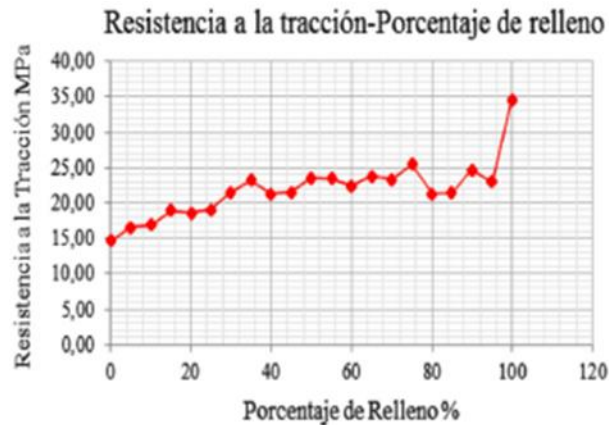
Figura 16: Gràfica comparativa assaig de tracció respecte percentatge d'emplenament. [9]
