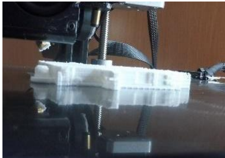
Figura 19: Exemple d'obstrucció total del broquet
