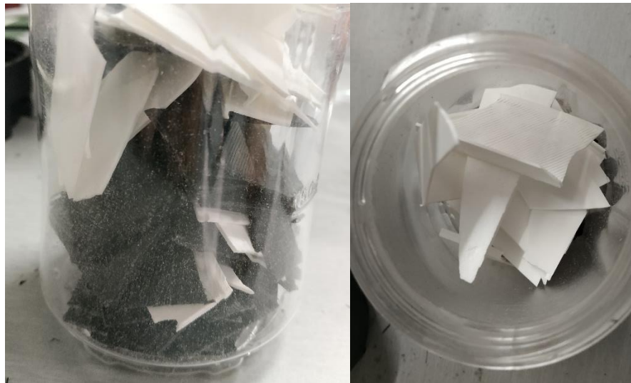
Figura 55: Restes PLA impressions 2-3 mm de gruix
