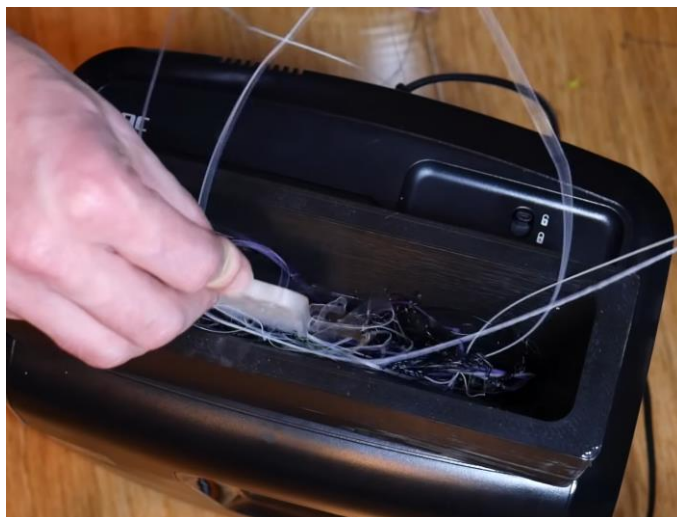
Figura 31: Trituradora de paper triturant plàstic [18]
