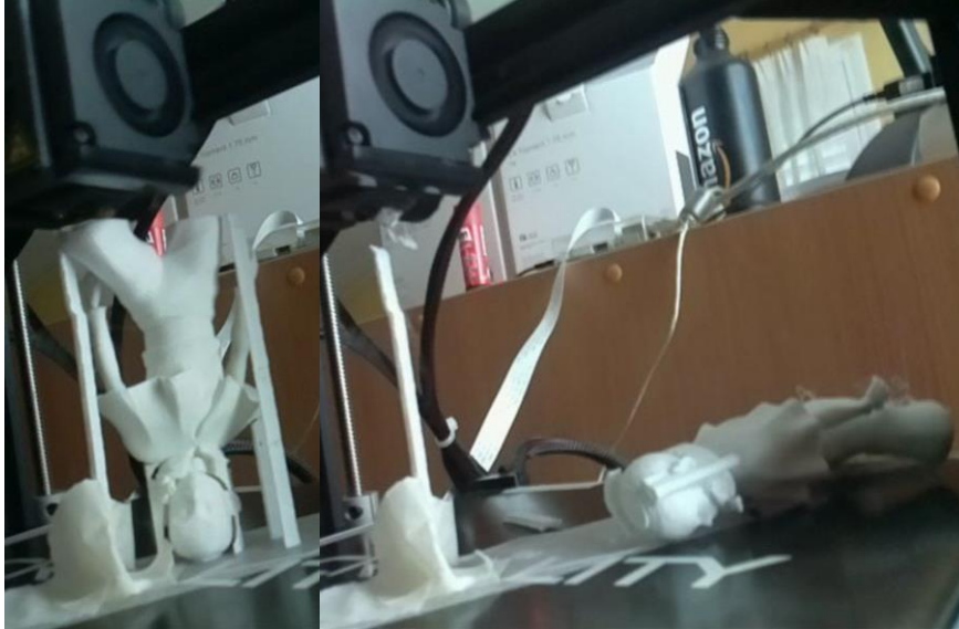
Figura 18: Exemple de caiguda d'un objecte durant la seva impressió
