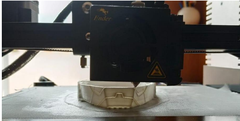
Figura 22: Exemple d'adhesió al llit amb cinta de pintor i pega de barra
