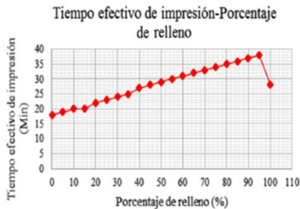
Figura 17: Gràfica comparativa temps efectiu d'impressió respecte percentatge d'emplenament [10]
