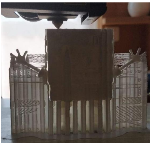
Figura 21: Exemple dels suports que es convertiran en residus
