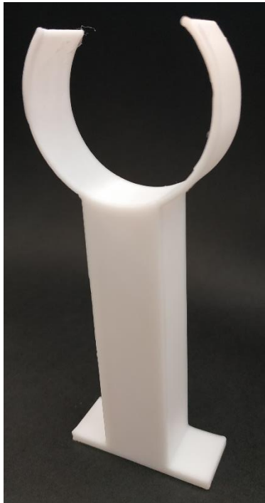
Figura 92: Suport barra central imprès en PLA
