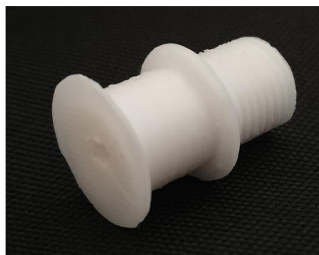
Figura 106: Adaptador motor 2 imprès en PLA
