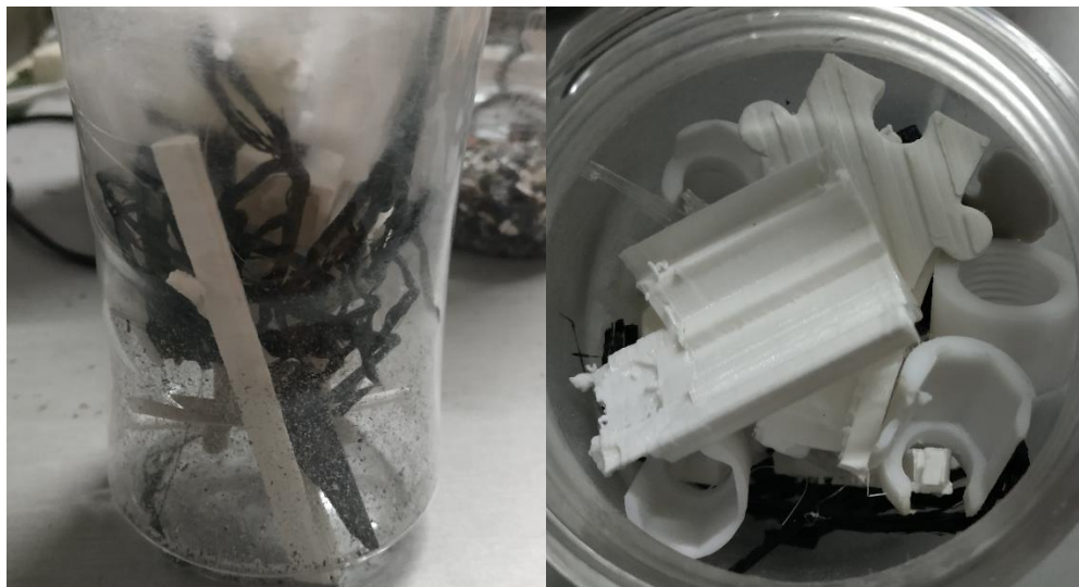
Figura 57: Restes 1 PLA impressions més de 4 mm de gruix
