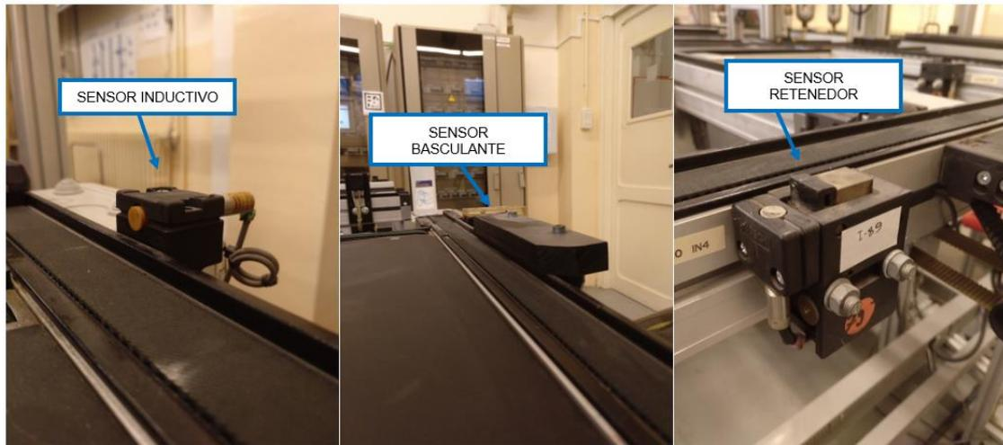
Figura 12: Diferentes sensores capacitivos de la célula industrial. Fuente: Elaboración propia
