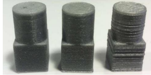
Figura V. Ejemplos de alturas de capa
