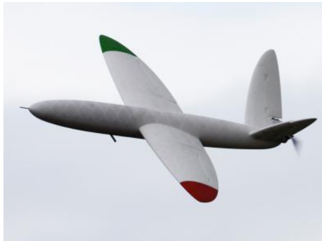
Figura 3. Primer avión no tripulado fabricado con una impresora 3D.
