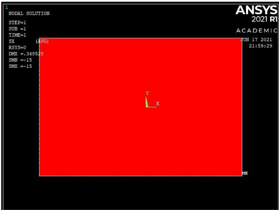
Figura 8.10 Distribució de tensions de la proveta a compressió per a una tensió de 15 MPa
