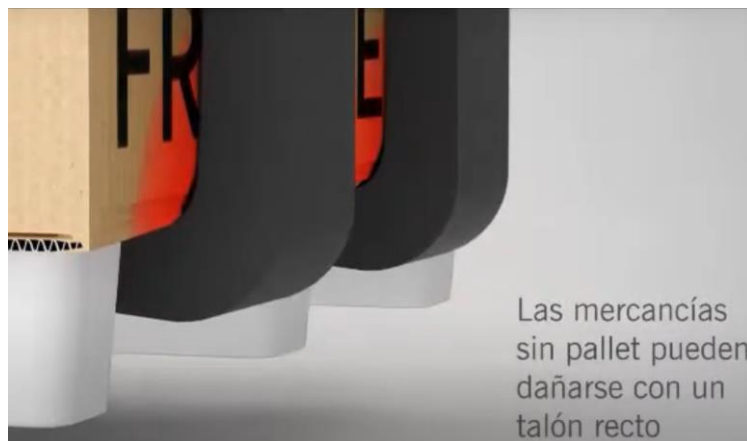
21 Ilustración de carga dañada por talón clásico
