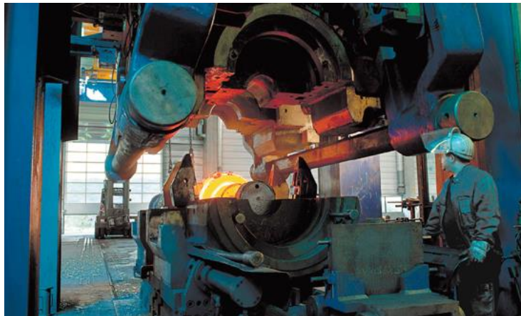
24 Imagen de forjado a niveles industriales para piezas de gran tamaño
