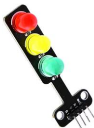
Figura 3.13: Semáforo utilizado en la maqueta, controlado por el módulo.
