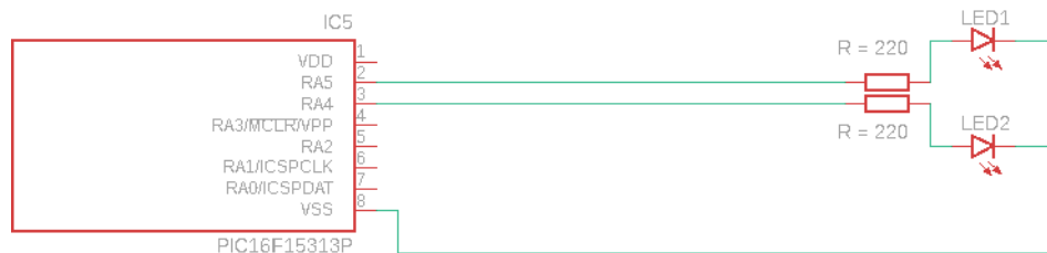
Figura 3.12: Esquemático del circuito para el control de semáforos.
