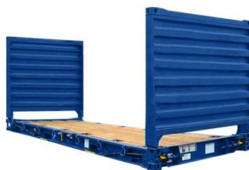
Il·lustració 9: Contenedor Flat rack (Fuente: http://www.pitarchlogistica.com/es/noticias/contenedores-transporte-maritimo-caracteristicas )
