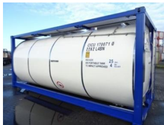
Il·lustració 8: Contenedor Tanque (Fuente: http://www.pitarchlogistica.com/es/noticias/contenedores-transporte-maritimo-caracteristicas )
