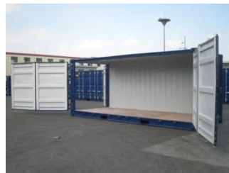
Il·lustració 7: Contenedor Open Side (Fuente: http://www.pitarchlogistica.com/es/noticias/contenedores-transporte-maritimo-caracteristicas )
