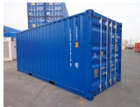
Ilustración 4: Contenedor Dry Van (Fuente: http://www.pitarchlogistica.com/es/noticias/contenedores-transporte-maritimo-caracteristicas )
