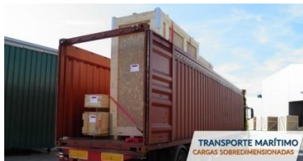
Ilustración 5: Contenedor Open Top (Fuente: http://www.pitarchlogistica.com/es/noticias/contenedores-transporte-maritimo-caracteristicas )
