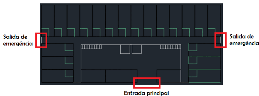
Ilustración 57: Localización de las puertas externas del edificio en plantas superiores (Elaboración propia)
