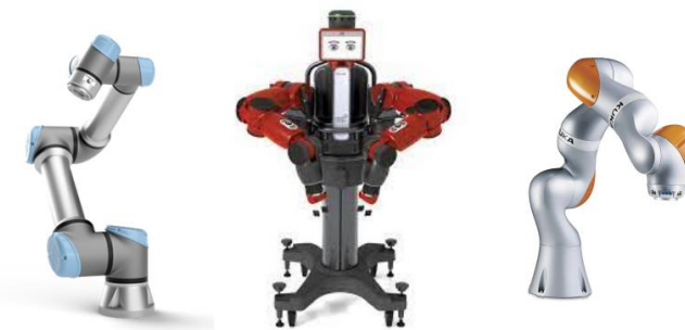
Figura 2 Robots col·laboratius UR3, Baxter i LBR, respectivament.
