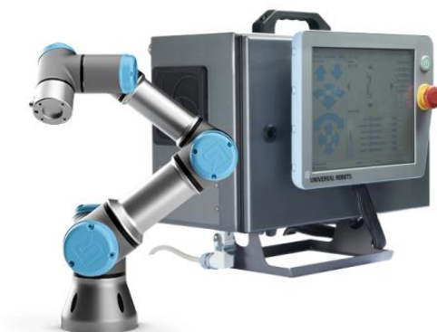
Figura 6 Conjunt d'un UR3: Braç, capsa de control i Teach pendant
