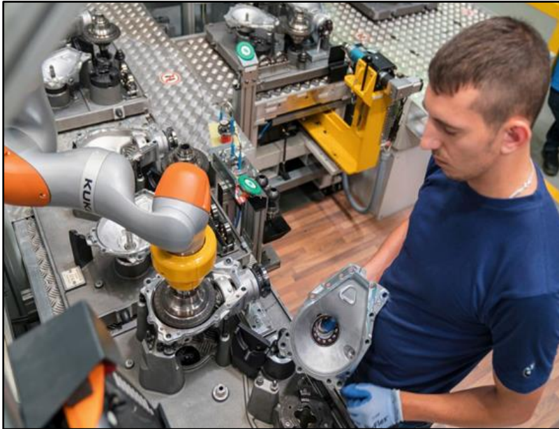
Figura 3 Un operari amb un robot col·laboratiu KUKA LBR
