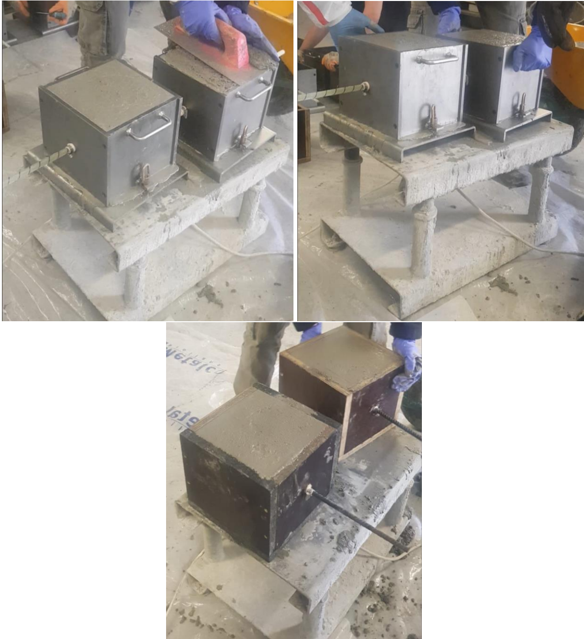
Figura 3.22 Compactación de las probetas con hormigón convencional C40
