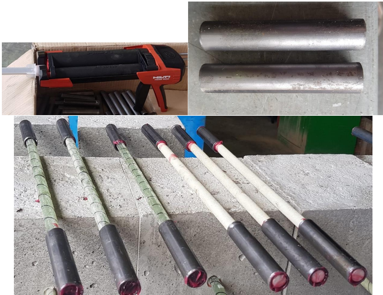
Figura 3.6 Protección de las barras FRP para ensayo a tracción
