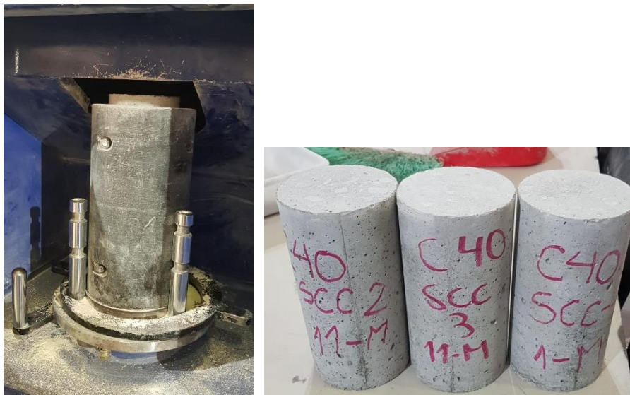
Figura 3.3 Pulido de las probetas previo el ensayo de compresión
