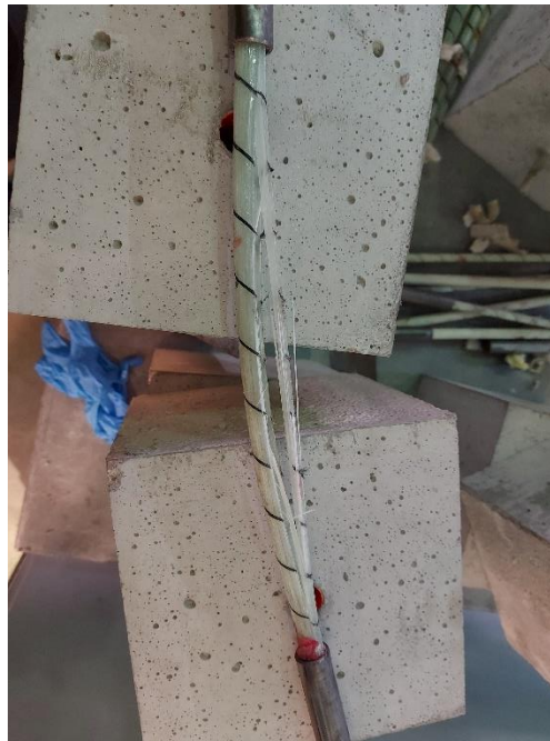
Figura 3.10 Falla de las barras FRP por desprendimiento de la resina
