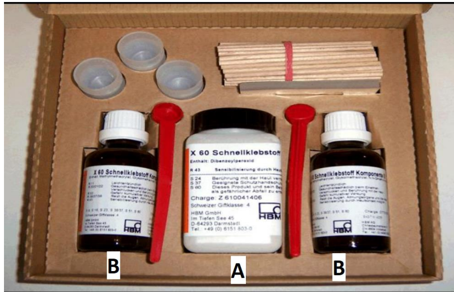
Figura 3.11 Adhesivo X60 utilizado para protección de los extremos de las barras FRP
