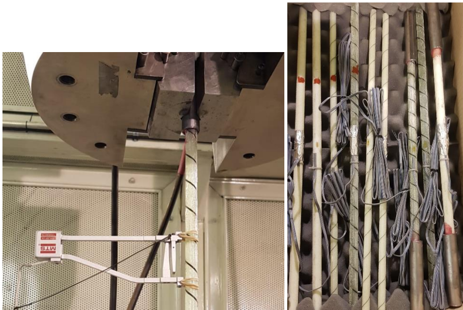
Figura 3.7 Extensómetro y galgas extensiométricas utilizadas en los ensayos de tracción
