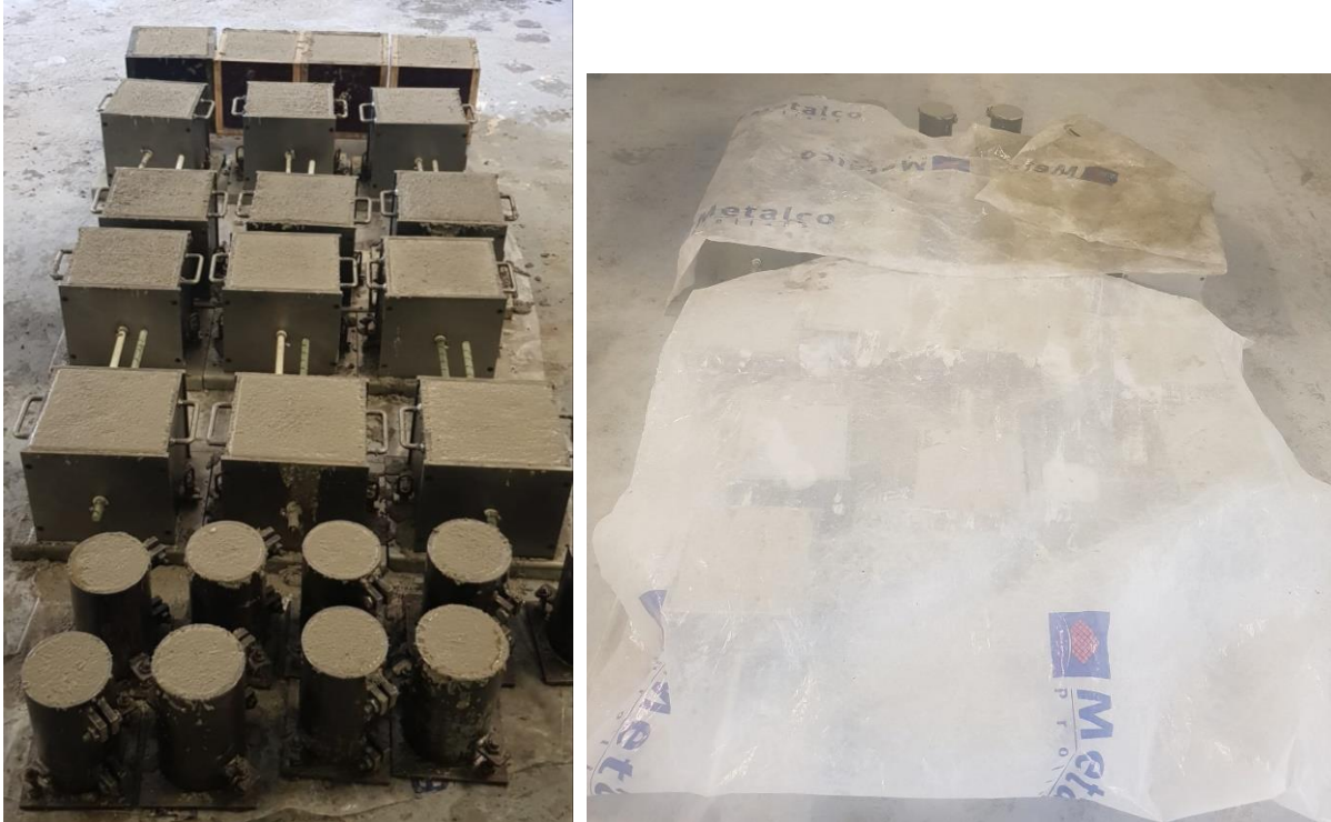
Figura 3.23 Probetas luego del hormigonado
