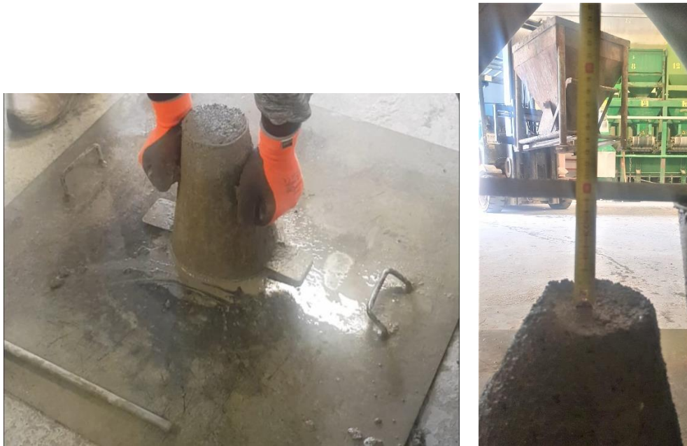
Figura 3.21 Ensayo de asentamiento con el cono de Abrams
