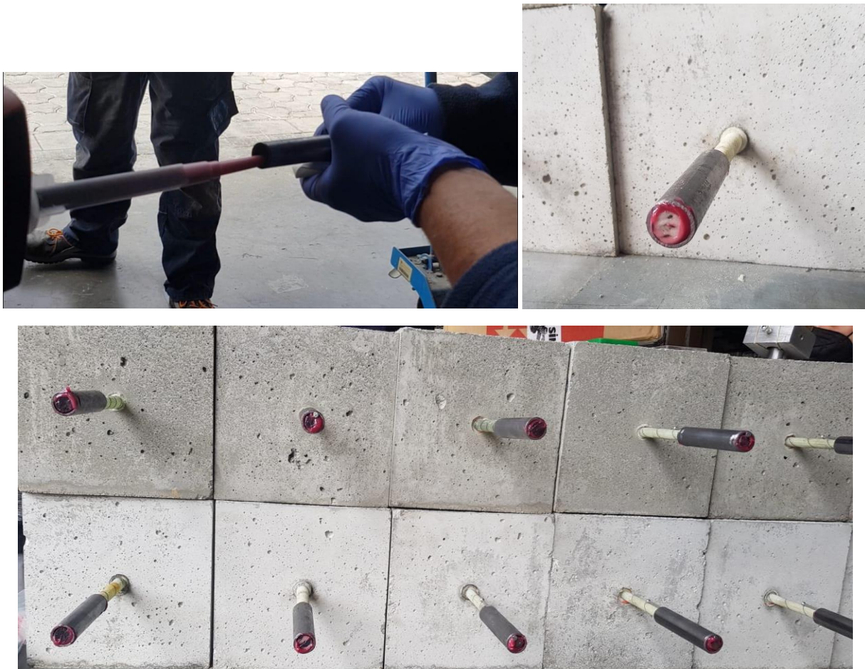
Figura 3.25 Colocación de la protección en el extremo cargado de la barra FRP
