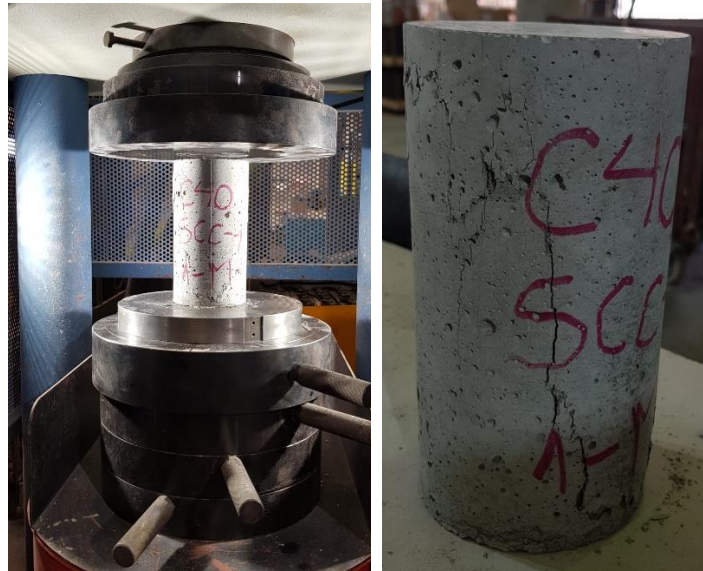
Figura 3.4 Ensayo a compresión del hormigón
