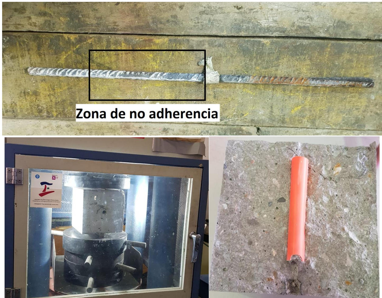
Figura 4.4 Verificación del deslizamiento del tubo PVC dentro de la probeta 3-ST-10-C40
