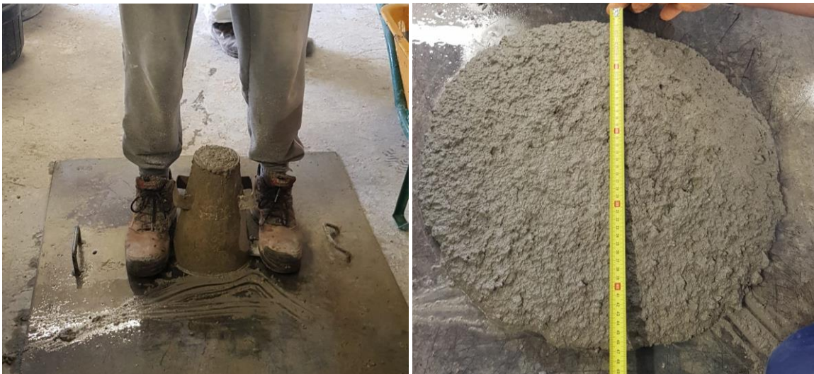
Figura 3.20 Ensayo de extensión de flujo
