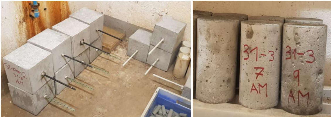
Figura 3.24 Probetas en cámara de curado
