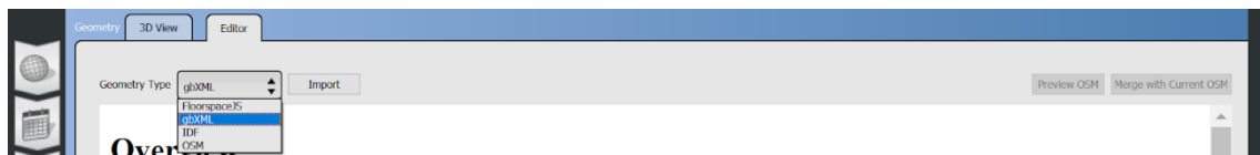
FIGURA 53. SELECCIÓ DE GBXML COM A GEOMETRY TYPE A LA FINESTRA EDITOR A OPENSTUDIO
