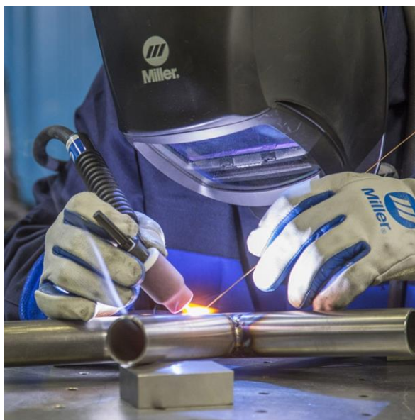
Imagen 24: Operario realizando soldadura TIG en tubos de acero. (Fuente: Ifap.com)
