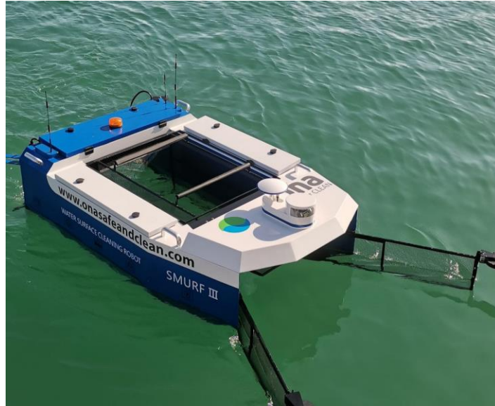
Figura 3: Dron utilitzat per a la recollida de residus en la superfície de l'aigua
