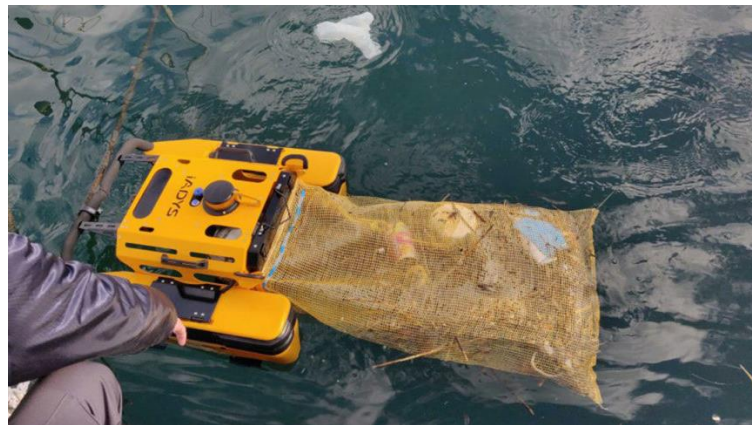
Figura 20: Sistema de captació de residus mitjançant una xarxa
