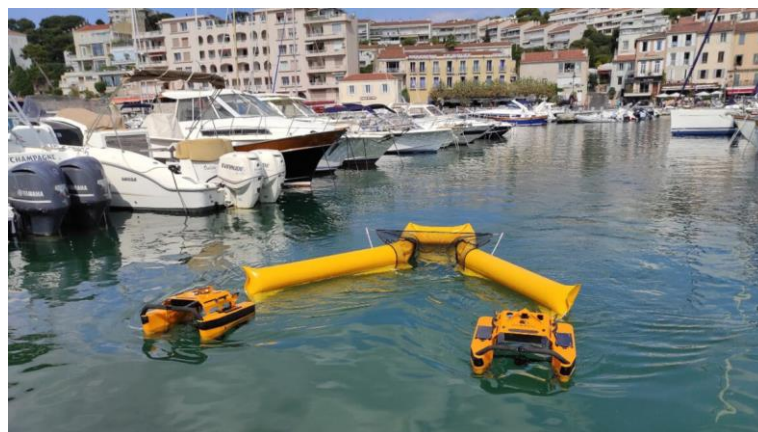
Figura 21: Incrementació de la capacitat de recollida per al sistema de captació de residus amb l'aplicació de dos drons i una barrera
