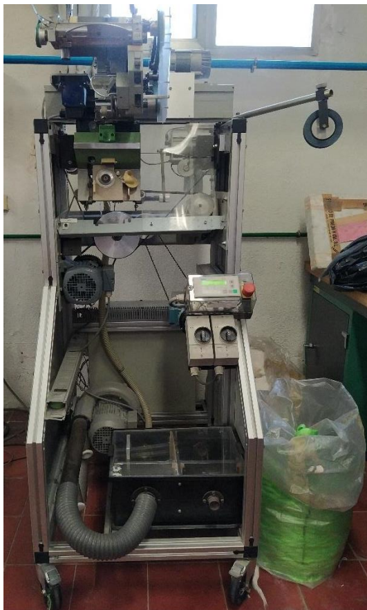
Figura 27. OE-rotor para hilatura Open-end de INTEXTER.
