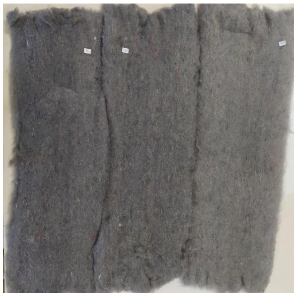
Figura 54. Napas resultantes de la carda con diferentes porcentajes de residuos.
