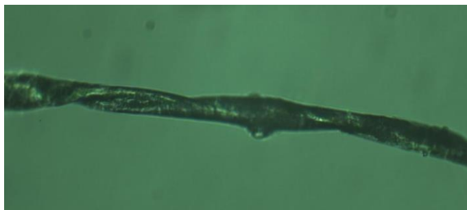
Figura 47. Vista longitudinal a microscopio de la fibra de algodón a 400 aumentos.
