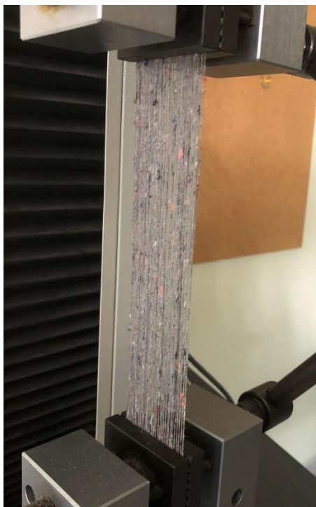
Figura 31. Probeta de 40 hilos en máquina universal para ensayos de tracción.
