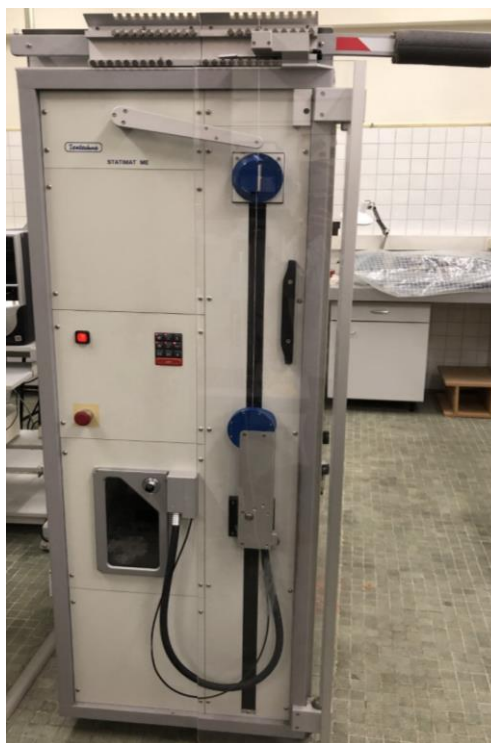
Figura 28. Dinamómetro de gradiente de alargamiento constante de INTEXTER.
