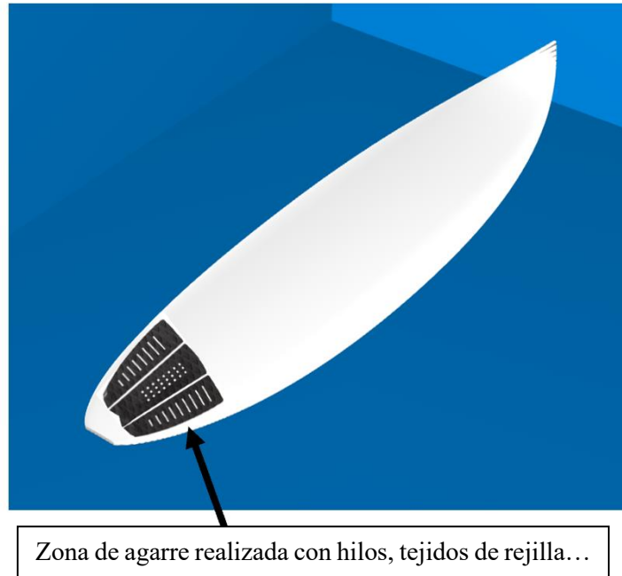
Figura 39. Ejemplificación de la zona de grip diseñada.
