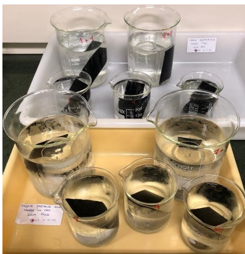
Figura 36. Probetas sumergidas en agua salada.
