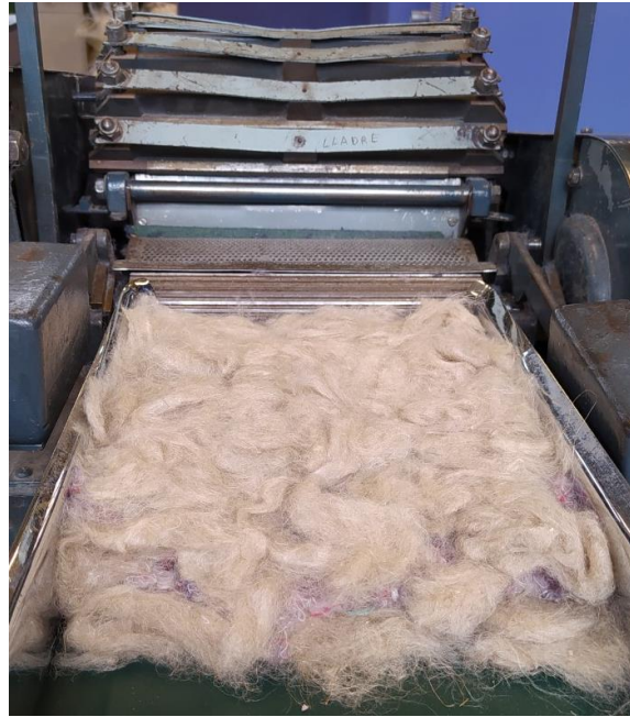
Figura 30. Disposición fibras en la entrada de la carda en tipo “sándwich”, fibras vírgenes en la parte superior e inferior y en medio las fibras de residuos textiles.
