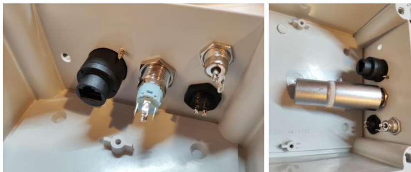
Fig. 4.11: Fijación de los puertos.
