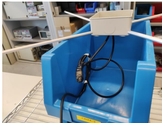
Fig. 3.21: Dipolo cruzado o Turnstile en pruebas.
