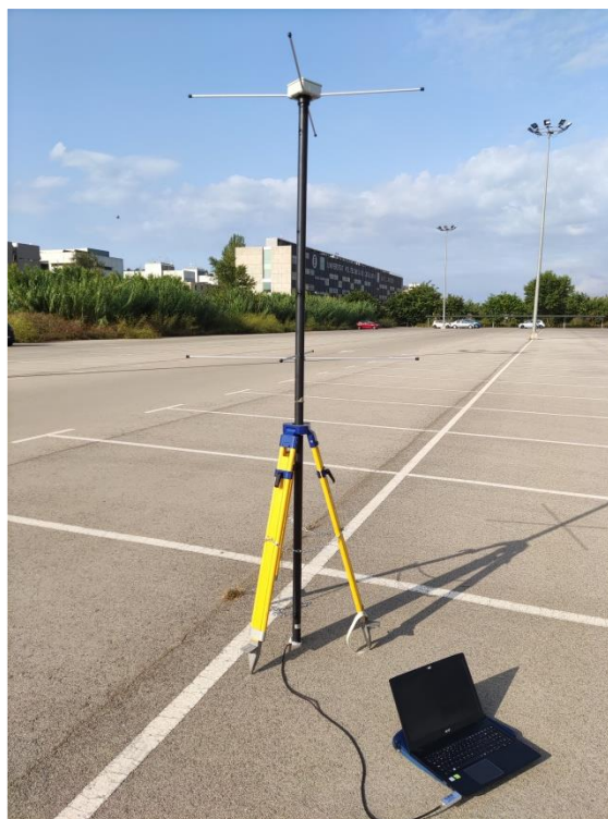
Fig. 3.39: Prueba de la antena Turnstile
