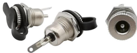
Fig. 4.4: Puertos barrel 5,5 x 2,1mm con tapa de goma.
