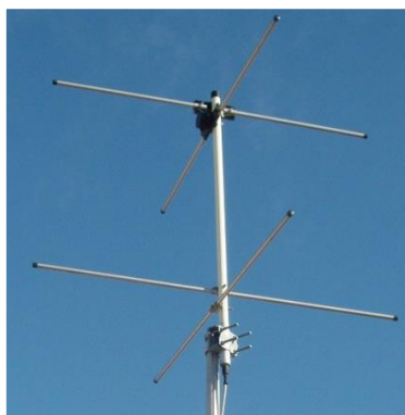
Fig. 3.3: Antena Turnstile con un reflector.
