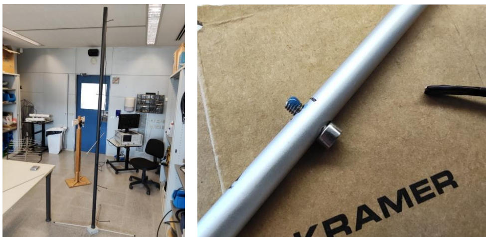
Fig. 3.37: Embridado del cableado al mástil y elemento del reflector con tornillo pasador con fijatornillos aplicado.
