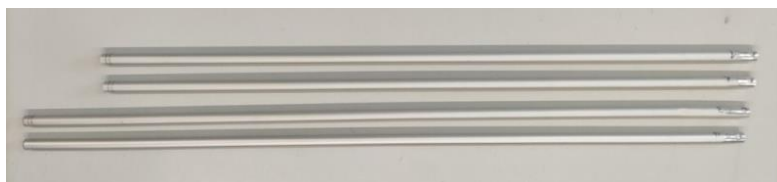
Fig. 3.15: Elementos de los dipolos acortados y elementos sin acortar.
