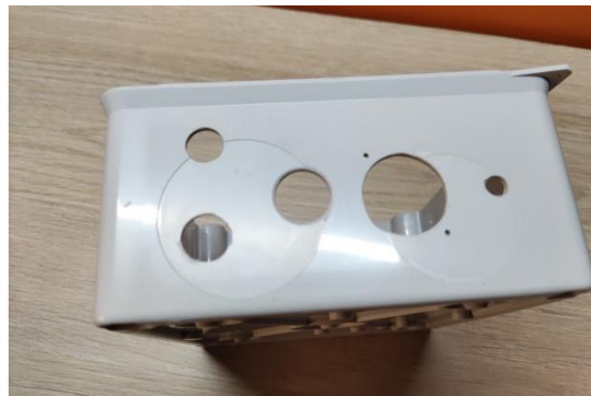
Fig. 4.10: Mecanizado de la caja estanca.
