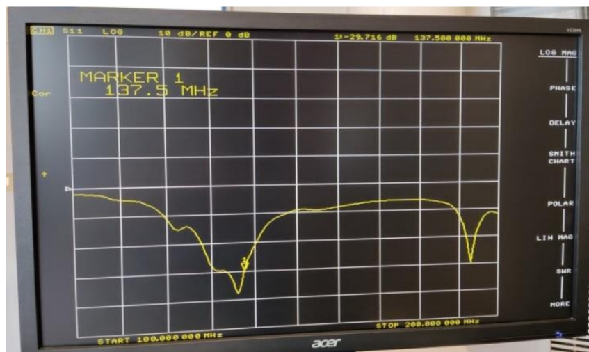
Fig. 3.29: Atenuación de la Antena Turnstile con el reflector a (1/2) \cdot \lambda
