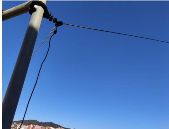
Fig. 3.1: Dipolo en V.
