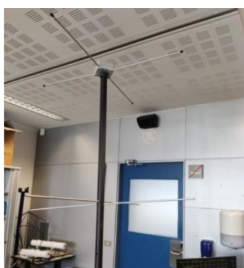
Fig. 3.32: Antena Turnstile con el reflector a (3/8) \cdot \lambda
