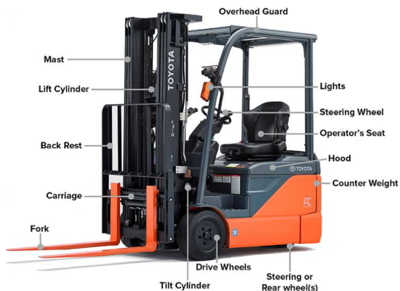
Fig. 7 Parts de la carreta elevador elèctrica. Font (Toyota, 2017).
