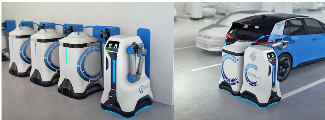
Fig. 5 (Esquerra) Estació de càrrega de bateries externes, (Dreta) Connexió al vehicle. (Volkswagen, 2019)
