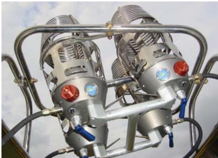
Fig 33. Sistema de combustió de 4 cremadors.
