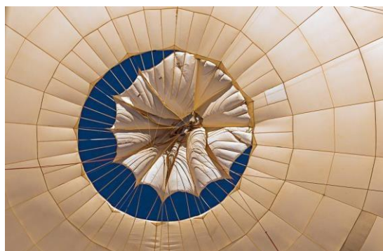
Fig 30. Vista des de dins de la tela, paracaigudes del globus.
