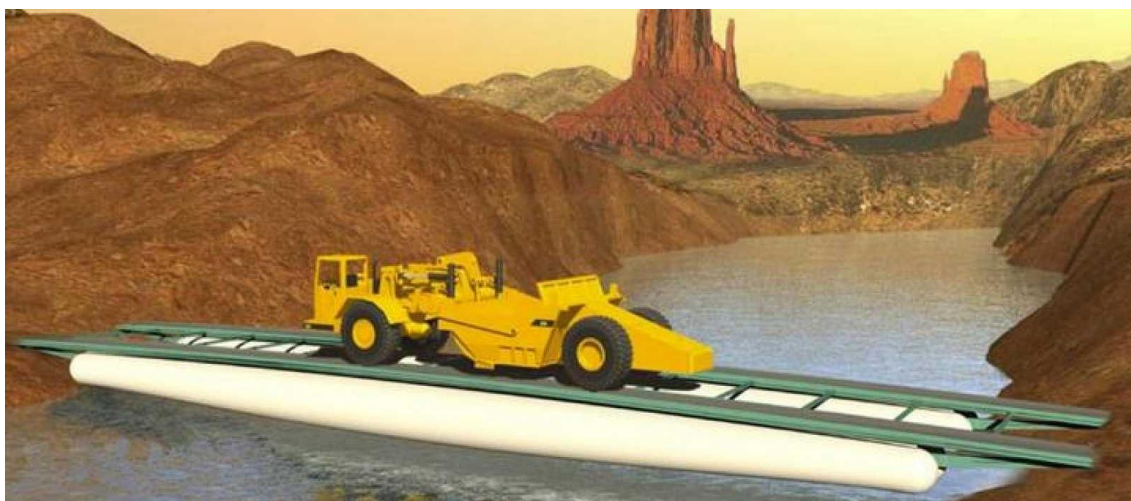
Fig 144. Exemple d'estructura, pont, rigiditzada amb tubs pressuritzats.
