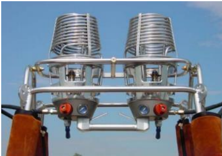
Fig 32. Sistema de combustió de 2 cremadors.
