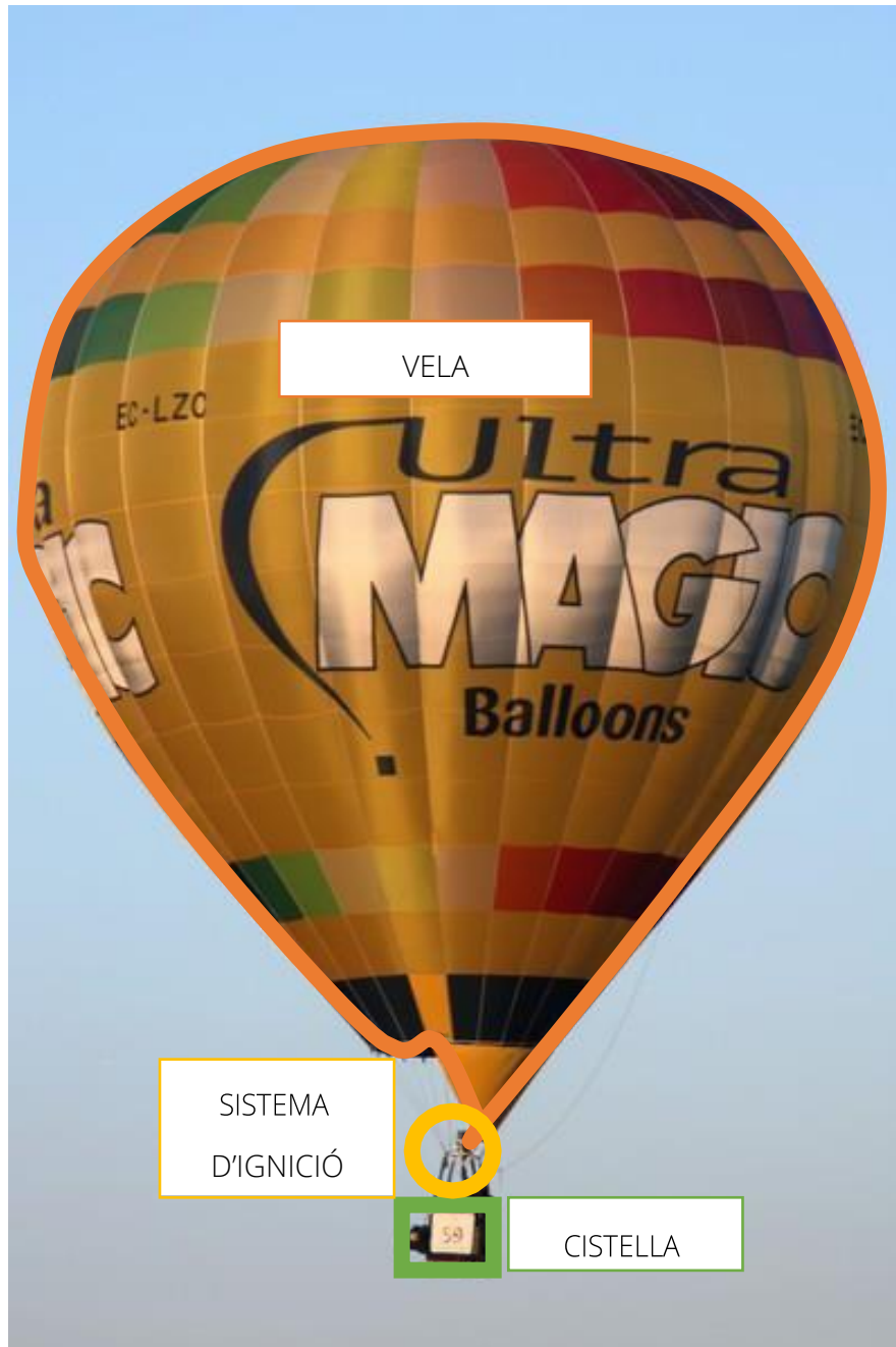
Fig 21. Descomposició en 3 parts principals del globus aerostàtic.
