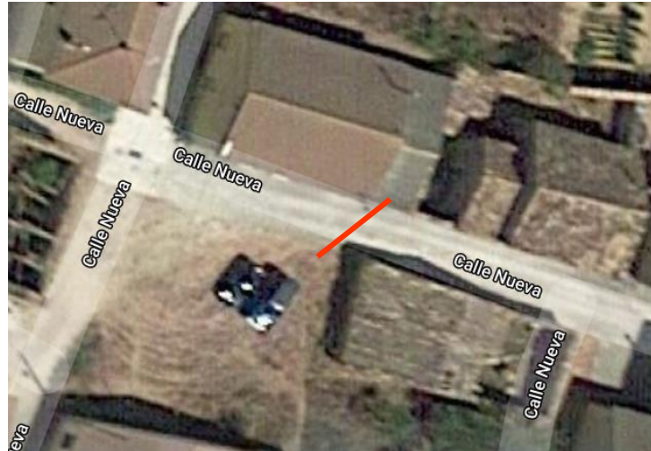
Figura 25: Soterrado del tramo módulos-reguladores
