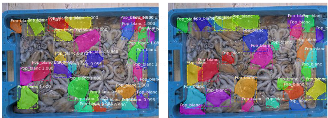
Figura 29: Màscares obtingudes del model de l'entrenament 2 (esquerra) i dibuixades a mà amb el labelme (dreta)
