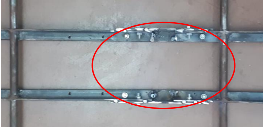
Figura 9. Solució a l'error de la distància entre les potes
