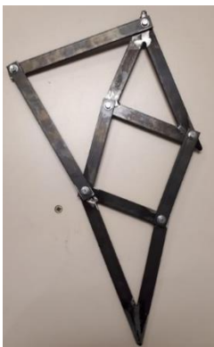
Figura 7. Mecanisme Theo Jansen d'elaboració pròpia
