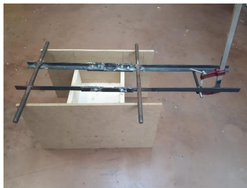
Figura 129. Barra d'enganxament a la bicicleta preparada per a soldar. Font: Elaboració pròpia
