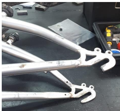
Figura 133. Part posterior del quadre de la bicicleta on s'uneix el conjunt de l'acoblament i el mecanisme caminador. Font: Elaboració pròpia
