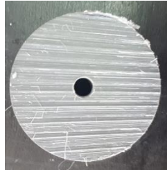
Figura 76. Forat roscat per poder fixar la peça a un tros de fusta. Font: Elaboració pròpia
