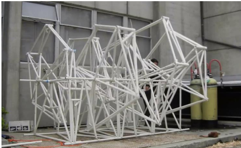
Figura 13. Màquina de caminar mecànica Ghassaei. Font: Amanda Ghassaei
