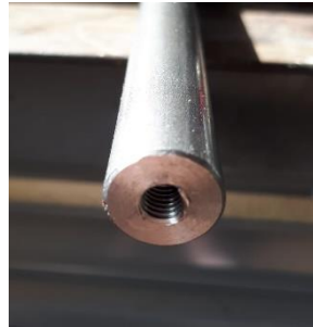
Figura 90. Forat roscat de la barra del segon punt fix. Font: Elaboració pròpia
