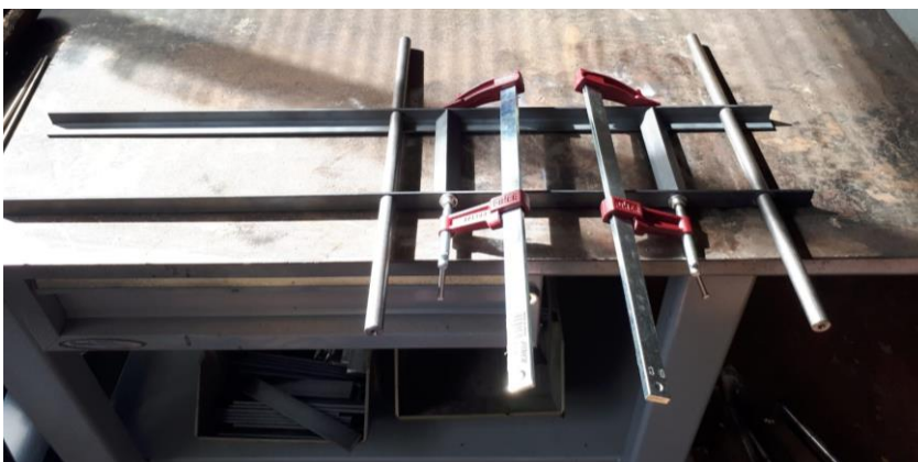
Figura 91. Conjunt dels perfils i les barres del segon punt fix. Font: Elaboració pròpia
