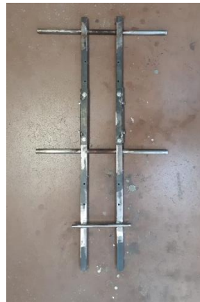
Figura 131. Barra d'enganxament a la bicicleta soldada 2. Font: Elaboració pròpia
