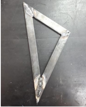
Figura 61. Estructura Peu soldada. Font: Elaboració pròpia
