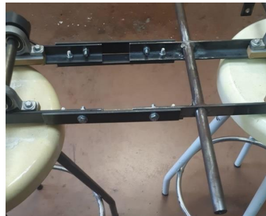
Figura 106. Barres cargolades als perfils 2. Font: Elaboració pròpia
