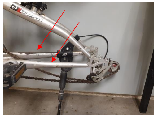
Figura 88. Banda interna de la part inferior del quadre de la bicicleta. Font: Elaboració pròpia
