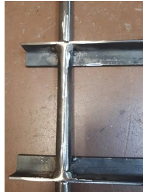
Figura 92. Soldadura de les barres i els perfils un cop esmolada 2. Font: elaboració pròpia
