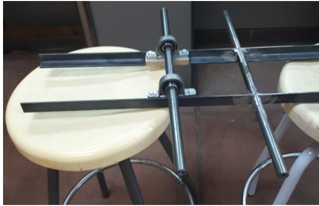
Figura 99. Muntatge de la peça suport coixinet, platina suport coixinet i coixinet sobre el perfil. Font: Elaboració pròpia
