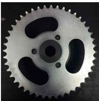
Figura 118. Plat a sobre de la peça per marcar el perímetre dels forats. Font: Elaboració pròpia
