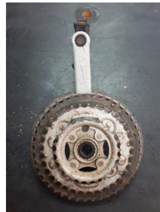
Figura 136. Plats i pedal extrets de la bicicleta. Font elaboració pròpia
