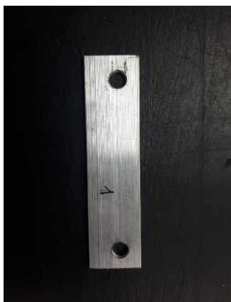
Figura 97. Platina suport coixinet foradada. Font: Elaboració pròpia
