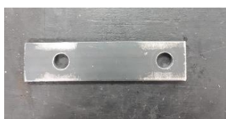
Figura 84. Manovella del mecanisme Theo Jansen. Font: Elaboració pròpia
