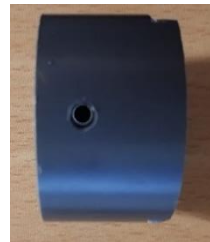
Figura 82. Forat passant perpendicular a les cares 2. Font: Elaboració pròpia
