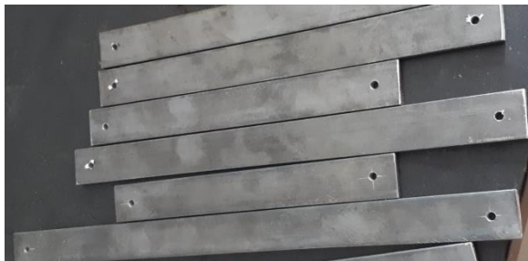
Figura 56. Exemple primer forat d'una barra. Font: Elaboració pròpia
