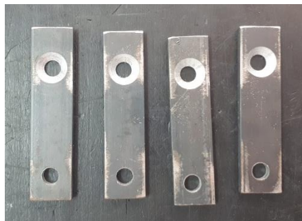
Figura 86. Avellanat d'un dels forats de la manovella. Font: Elaboració pròpia
