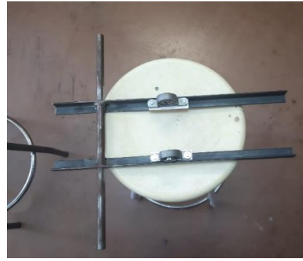
Figura 101. Part davantera dels perfils un cop tallats. Font: Elaboració pròpia
