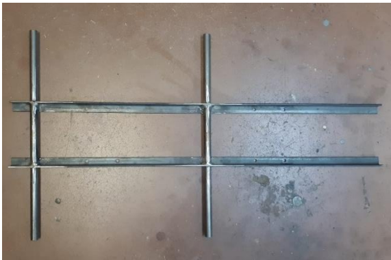
Figura 93. Soldadura de les barres i els perfils un cop esmolada 1. Font: Elaboració pròpia
