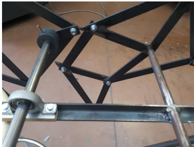
Figura 100. Punt on xoquen les potes. Font: Elaboració pròpia
