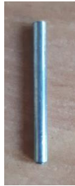
Figura 95. Vareta de l'acoblament de les potes i la barra accionadora. Font: Elaboració pròpia
