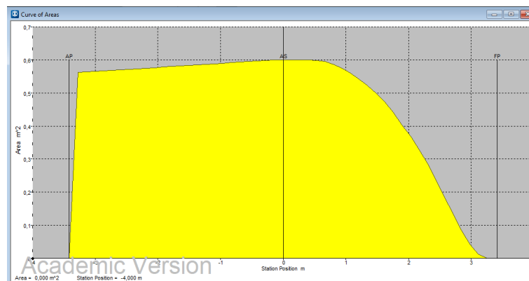
Ilustración 30: Curva de áreas en función de la sección para el modelo sin guías de agua
