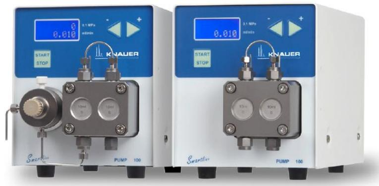
La bomba de líquidos utilizada es una Smartline Pump 100 Manual, de la marca *Knauer*. Este dispositivo es alimentado mediante corriente alterna con una tensión de 100 a 240 voltios. Incorpora un sensor de presión.
