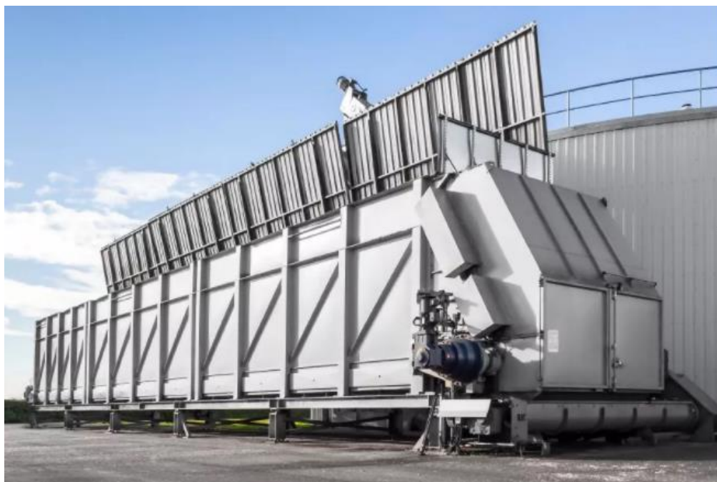
Figura 11: Imatge de la tolva receptora. Font: ZORG Biogas
