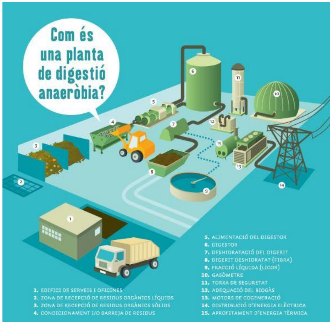
Figura 3: Parts d'una central de valorització energètica. Font: Agència de Residus de Catalunya.
