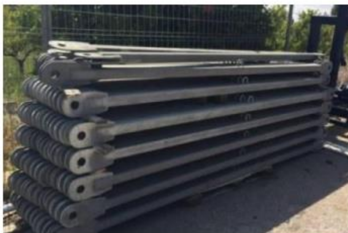
Figura 4.3. Conjunt de tirants utilitzats en una torre grua. Font: gruasyequiposgarcia.com.
