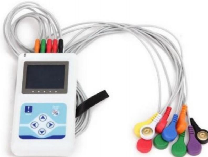
**Figura 4.** Dispositivo Holter 24 horas, de 12 derivaciones.<sup>[18]</sup>
