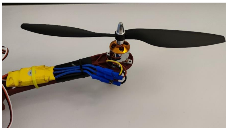
Figura 3.10. Montaje del motor, con la hélice, y el ESC en un eje del Frame
