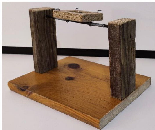
Figura 3.14. Fotografía de la plataforma de pruebas para el control PID
