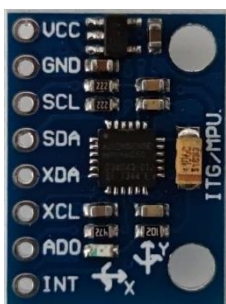
Figura 2.1. Fotografía de un módulo electrónico GY-521 (IMU)
