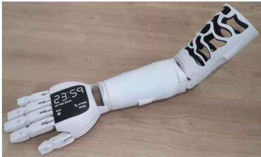
Figura 6. Maqueta de la prótesis.
