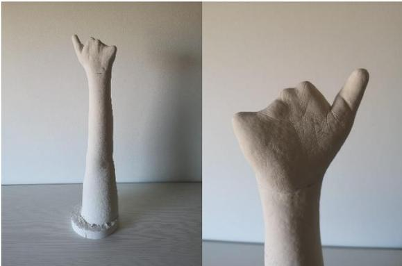
Figura 3. Molde de yeso del brazo del usuario.
