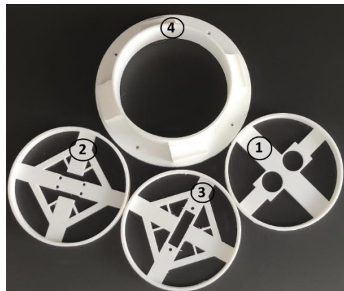
Ilustración 4: Soportes sensores y tubo. Fuente: Propia.
