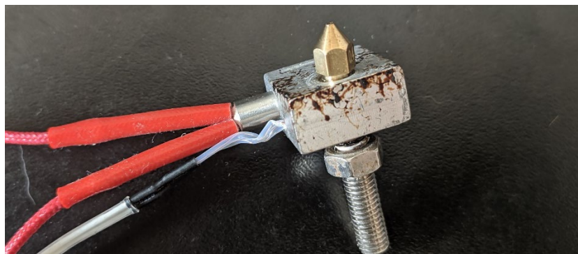
Figura 14. Hotend amb resistència i termistor. (Font: pròpia)
