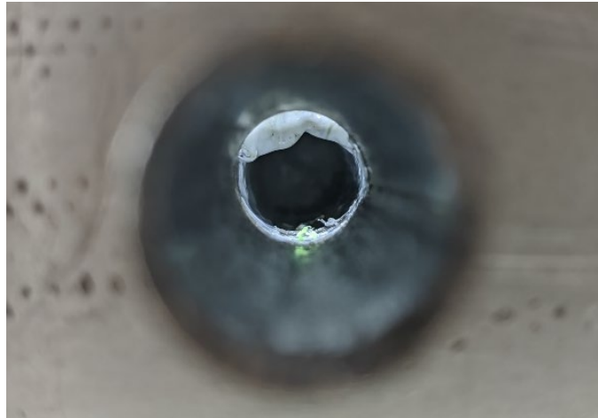
Figura 47. Restes de polímer al tub injector en retirar el pistó. (Font: pròpia)
