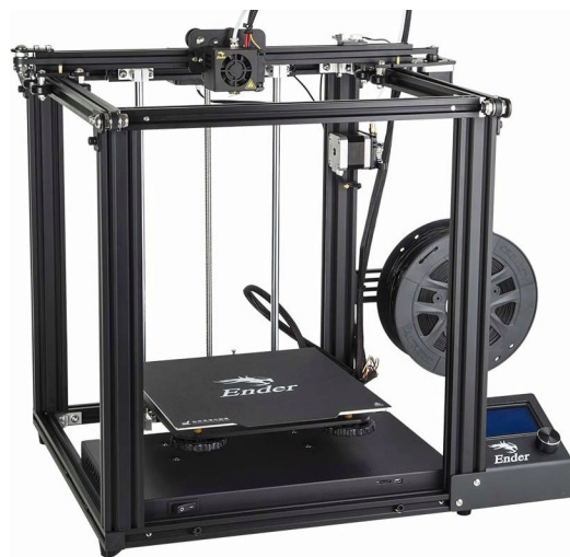
Figura 13. Creality ender 5 amb l'estructura de perfils d'alumini. (Font: Creality3D)
