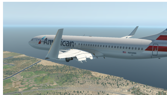
(b) Ala del avión B737 con flaps completamente extendidos (40°)
