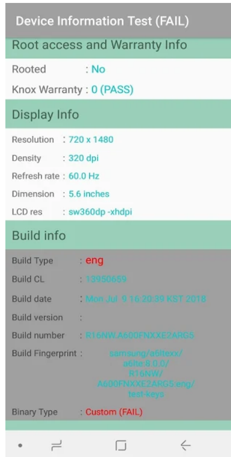
Figura 3: Test "27. Device Information Test" de Samsung Device Checker (Fuente: [21]).
