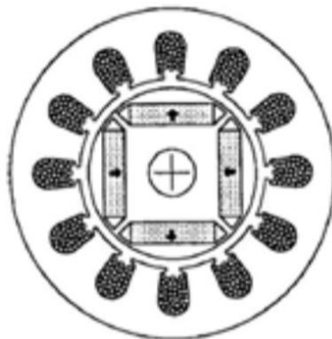
Ilustración 7.- Rotor interior de imanes interiores tangenciales.(8).
