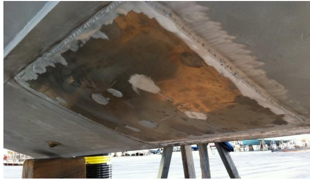
Figura 21 - Exemple de reparació en metalls. Font: reparacionesnavalesencanarias.com
