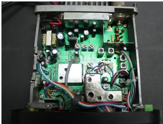
Figura 34 - Interior d'una ràdio VHF. Font: electronicapascual.com
