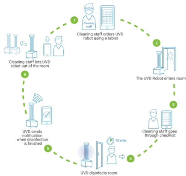
Imatge 11. Cicle de funcionament UVD Robot Model B
