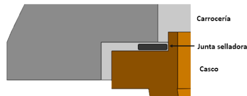
Figura 60. Capas en el montaje del casco y carrocería (Fuente: elaboración propia).
