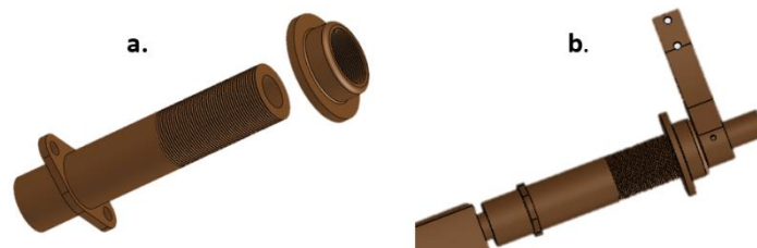
Figura 77. a) Alojamiento del timón y pieza tope. b) Montaje del timón en el alojamiento (Fuente: elaboración propia).
