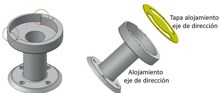
Figura 75. Alojamiento columna de dirección y tapa del alojamiento (Fuente: elaboración propia).
