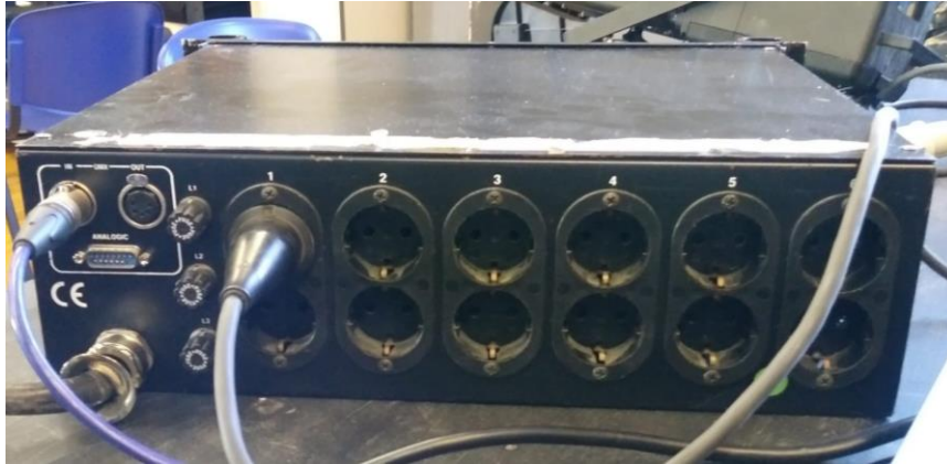
Il·lustració 25: Dimmer trifàsic MIZAR per darrere. Font: Pròpia-material de l'ESTAE
