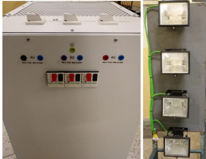
Il·lustració 6: D'esquerra a dreta: Càrregues resistives i focus halògens. Font: Pròpia-material UPC
