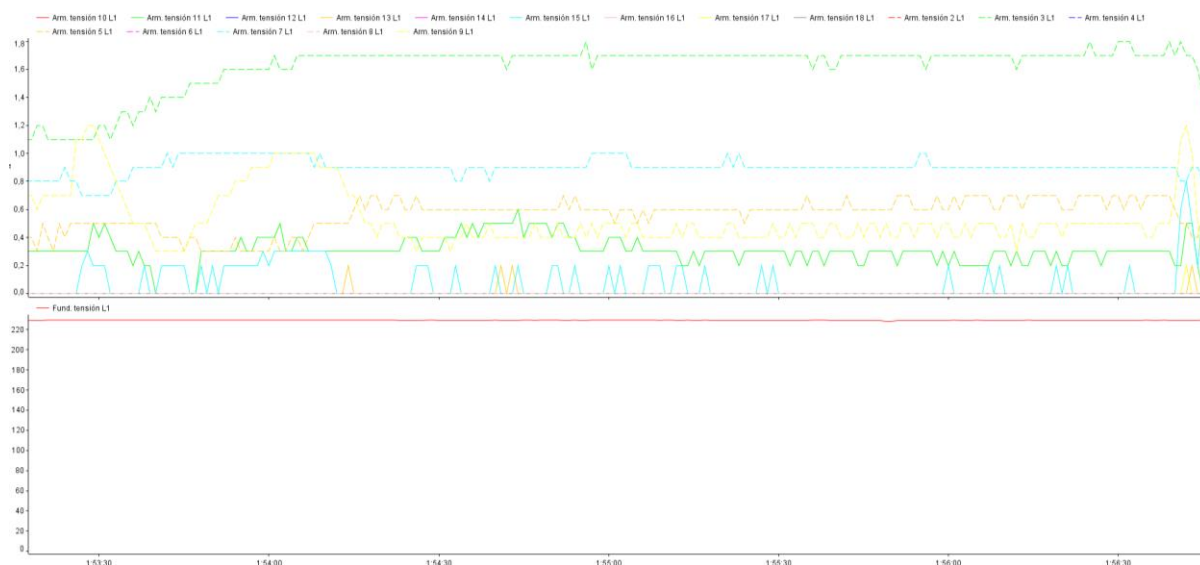
Gràfic 29: Anàlisi de les mesures en el Teatre Alegria: Altaveu professional: harmònics de tensió 1 a 18
