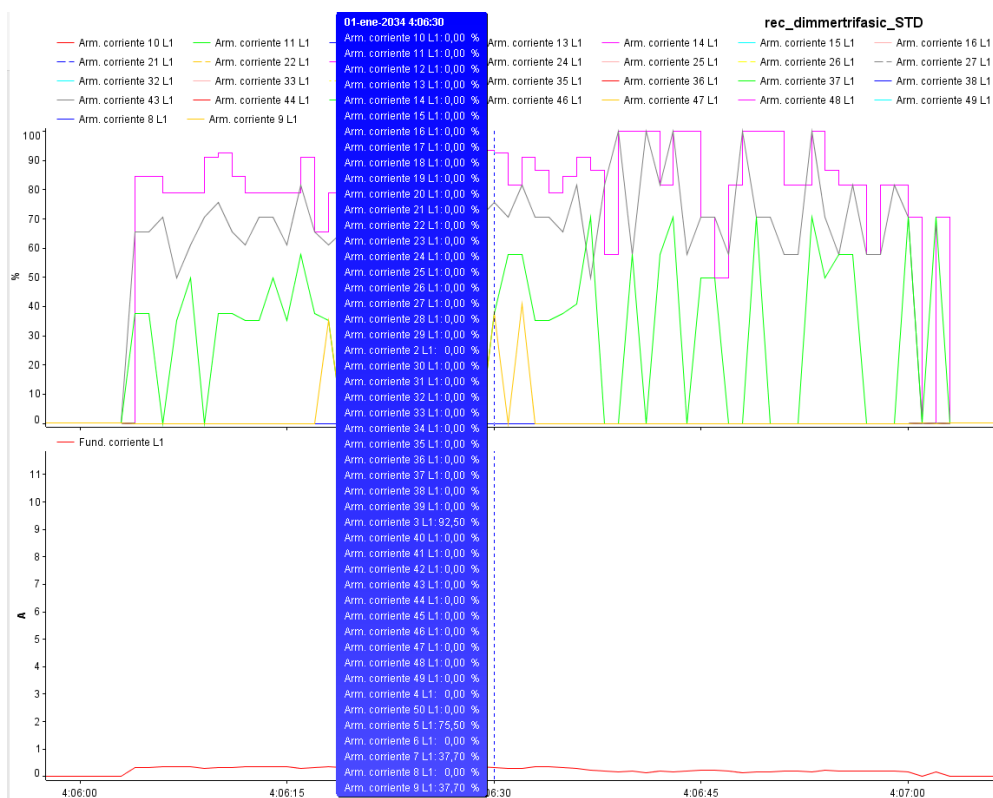
Gràfic 14: Mesures de càrregues a la UPC: Focus halògens de la UPC: harmònics de corrent
