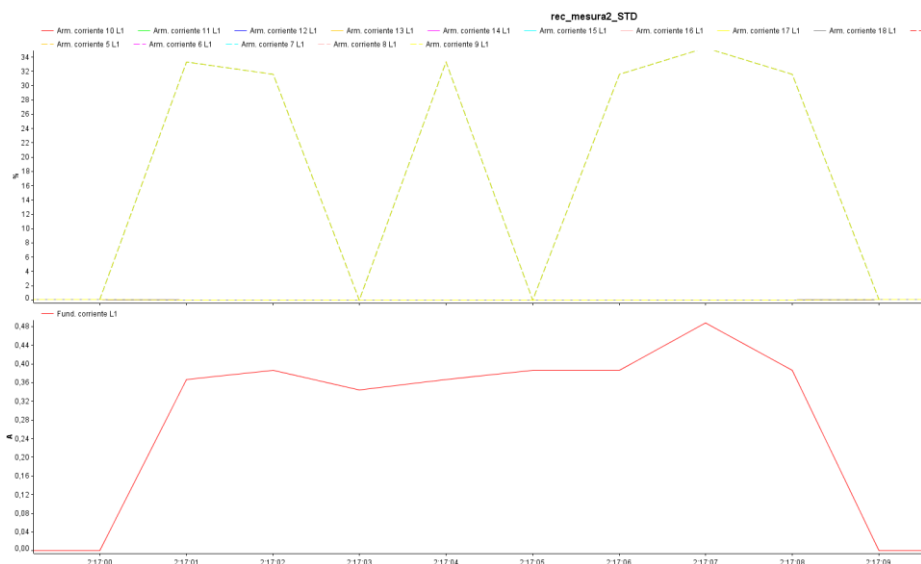
Gràfic 42: Anàlisi de les mesures en el Teatre Alegria: Etapa de potència: harmònics de corrent L1 1 a 18 (Zoom In)
