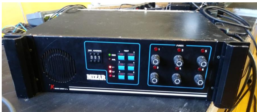
Il·lustració 24: Dimmer trifàsic MIZAR per davant. Font: Pròpia-material de l'ESTAE
