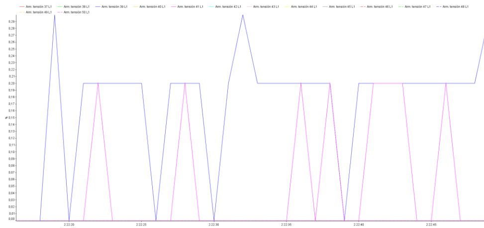
Taula 43: Anàlisi de les mesures en el Teatre Alegria: Etapa de potència: harmònics de tensió L1 37 a 50
