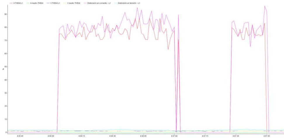
Gràfic 12: Mesures de carregues a la UPC: Focus halògens de la UPC: Índex de distorsió harmònica (THD)
