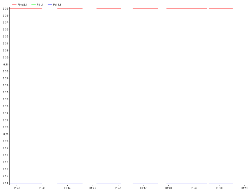
Gràfic 18: Anàlisi de les mesures en el Teatre Alegria: Focus BPP210 LED amb dimmer monofàsic: Flicker
