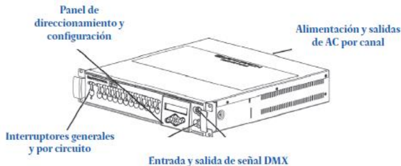
Il·lustració 49: Parts d'un Dimmer. Font: [57]
