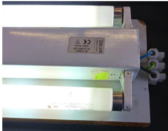
Il·lustració 19: Tub fluorescent Sylvania. Font: Pròpia-material de l'ESTAE
