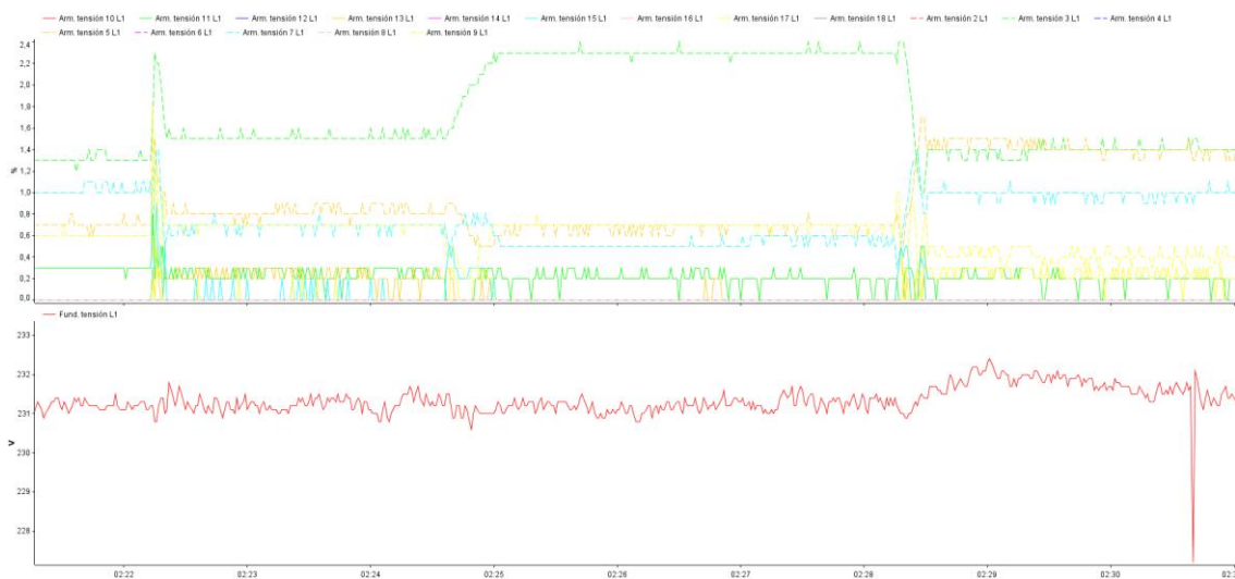
Gràfic 39: Anàlisi de les mesures en el Teatre Alegria: Etapa de potència: harmònics de tensió L1 1 a 18
