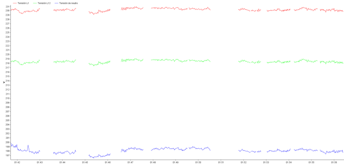
Gràfic 15: Anàlisi de les mesures en el Teatre Alegria: Focus BPP210 LED amb dimmer monofàsic: Tensió L1
