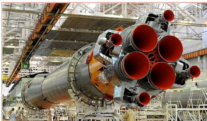
Figura 2.4. Segunda etapa del cohete ruso Soyuz. Se puede apreciar la matriz de empuje principal, y cuatro propulsores de Vernier con un grado de libertad cada uno. (Fuente: russianspaceweb [6]).
