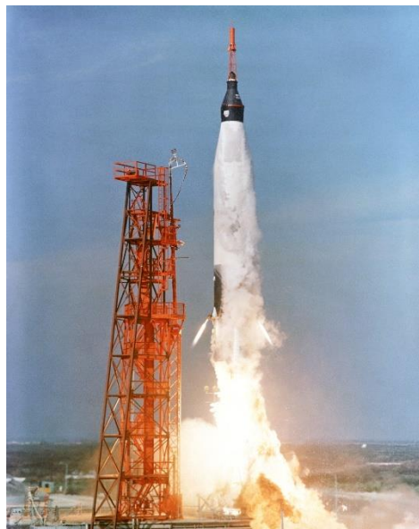
Figura 2.5. Lanzamiento del Mercury-Atlas 5. Se pueden apreciar los pequeños propulsores de Vernier en el perímetro del cohete. (Fuente: NASA [7]).
