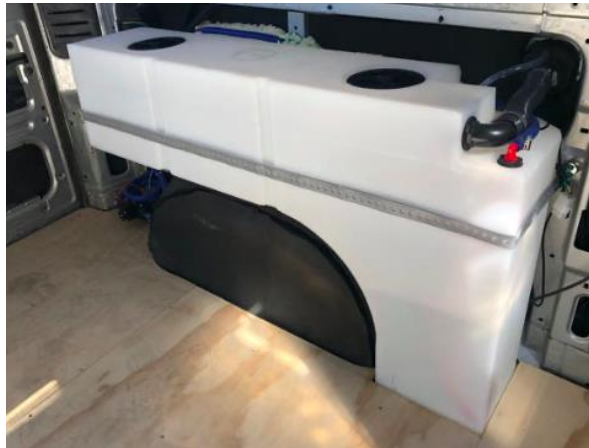
Figura 31. Depòsit d'aigua neta instal·lat sobre pas de roda
