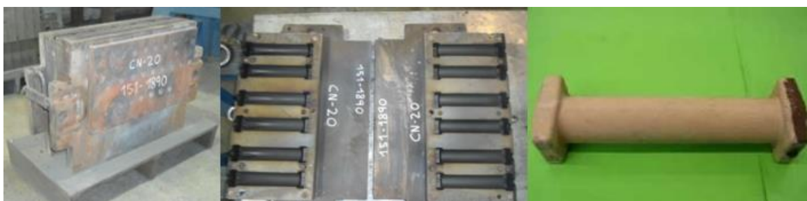
Ilustración 4. En la izquierda el exterior de una caja de machos, en el centro su interior y en la derecha el noyo que se produce con esta caja. (Fuente: Elaboración propia)
