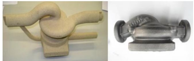
Ilustración 3. Ejemplo de un noyo usado para la fabricación de una bomba de agua. (Fuente: Elaboración propia)
