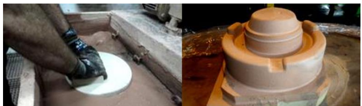
Ilustración 13. Proceso del pintado por sumersión a la izquierda, macho pintado a la derecha. (Fuente: Elaboración propia.)
