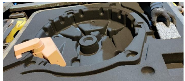
Ilustración 2. Mitad de un molde con el noyo ya colocado. (Fuente: Elaboración propia)
