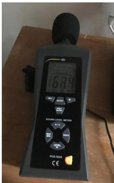
Figura 4.6. Sonómetro PCE 322A (Fuente: Nil MOREU BARRA)
