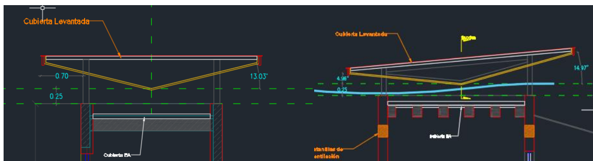
Il·lustració 11. Alçat (esquerra) i vista lateral (dreta) d'una iteració de disseny de la coberta.
