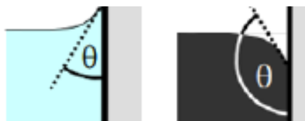
Il·lustració 2. Exemples de diferents meniscs de contacte entre líquid i superfície. Imatge extreta de la referència [3].
