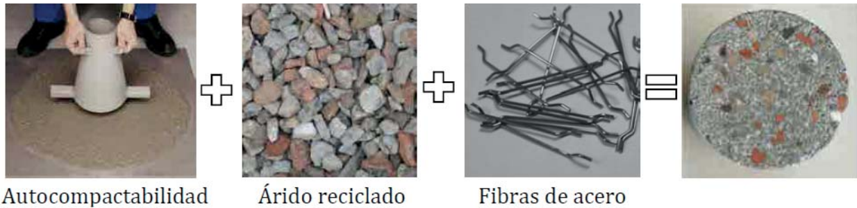
Figura 2. Representación de un hormigón autocompactante con árido reciclado y fibras. (Mena, 2015).
