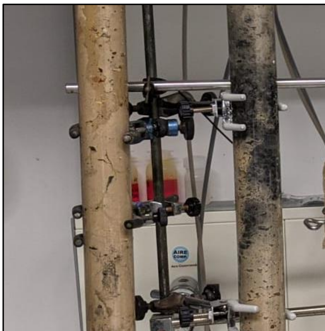
Imatge 11. Comparació entre l'estat final de la columna A i la B que té bombolles degut a l'activitat bacteriana.
