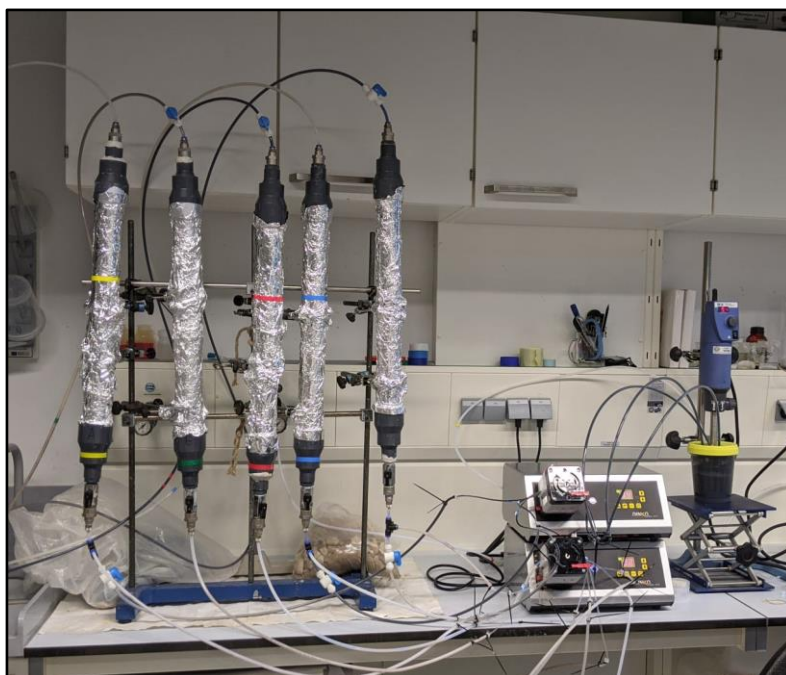
Imatge 7. Muntatge complet per la injecció de les nanopartícules de ferro.
