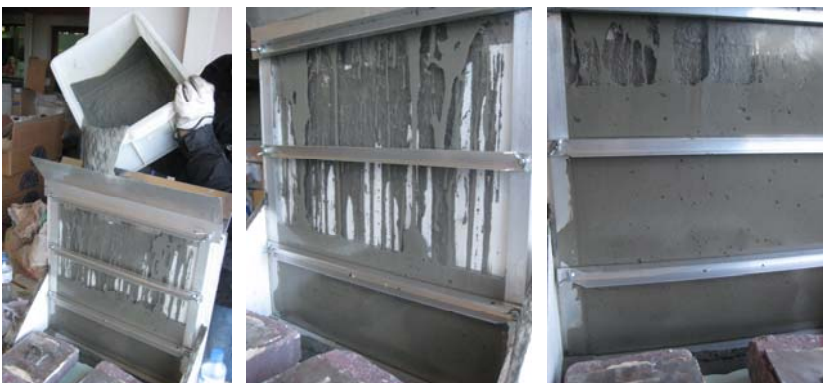
Figura 10. Imágenes del proceso de vertido para la entrada de 12mm
