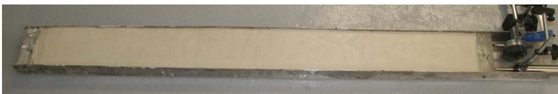
Figura 5. Molde en forma de 'U', con comparador digital en el extremo móvil.
