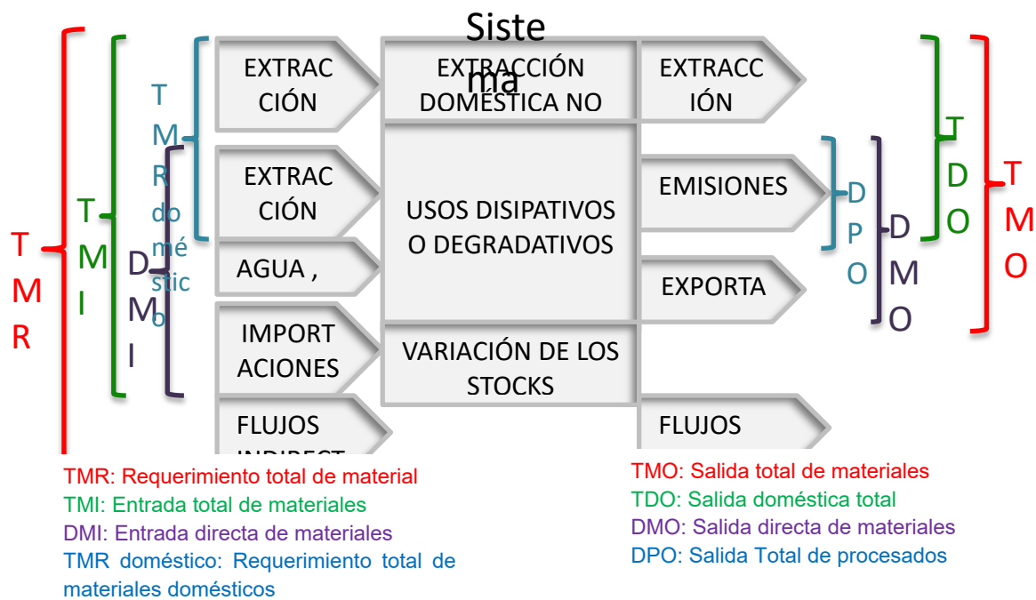
Figura 3. Definición y cálculo de flujos de entrada y salida del MFA.
