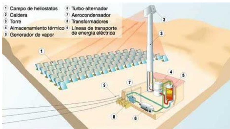
Fig 17. Esquema de uma usina termossolar heliotática. Fonte: https://globalelectricity.wordpress.com/category/centrales-electricas/
