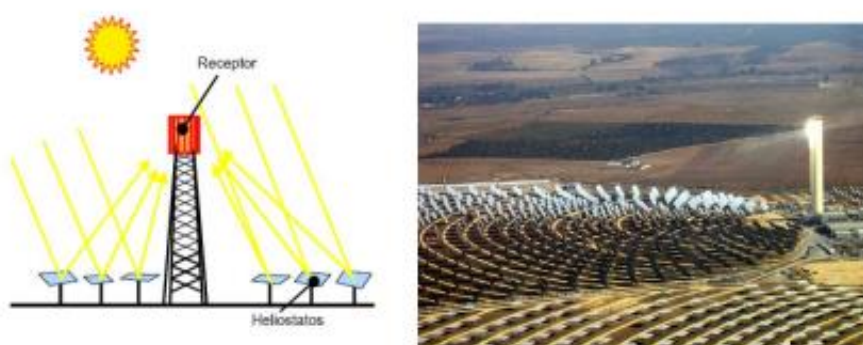
Fig 19. Usina térmica solar da torre. Fonte: http://www.esrenovable.com/2011/09/tipos-de-centrales-solares.html
