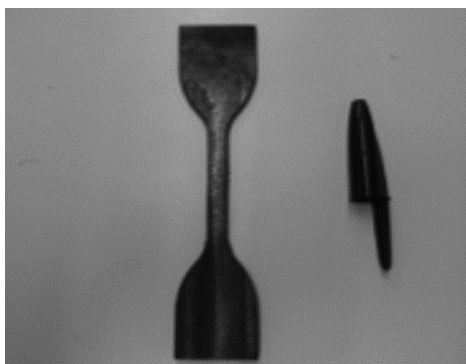
Figura 1. detalle de las muestras que se utilizaron para los ensayos mecánicos.
