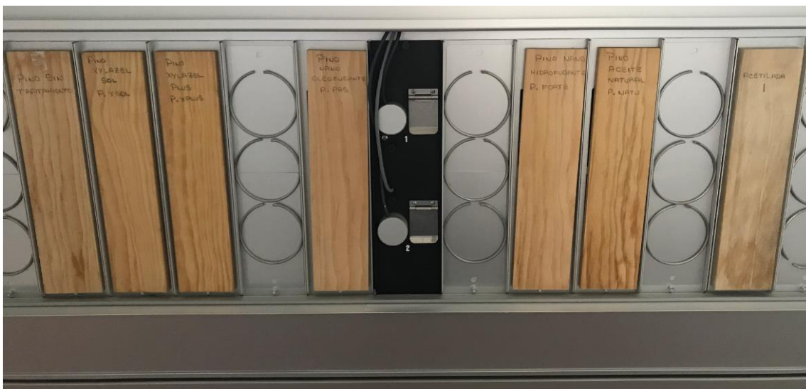
Figura 4.3. Muestras de pino dentro de la máquina QUV
