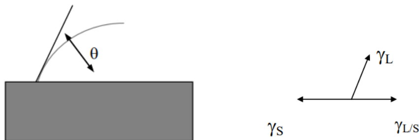
Figura 4.8. A la izq. Ángulo de contacto y a la derecha las tensiones superficiales Fuente: PDF de J. Torrent Burgués FOOT-UPC, Terrassa [8]
