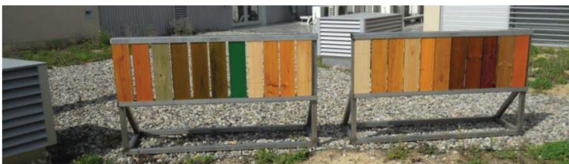
Figura 3.1. Expositor con las probetas en cubierta de EPSEB. Fuente: Tesis de Camila Burgos [4]
